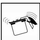
Agitati inainte de mixarea culorii. Pigmentii metalici MM 800 , inainte de prima utilizare trebuie amestecati bine pentru omogenizare urmand ca mai apoi sa fie agitati la fel ca si ceilalți pigmenti .
